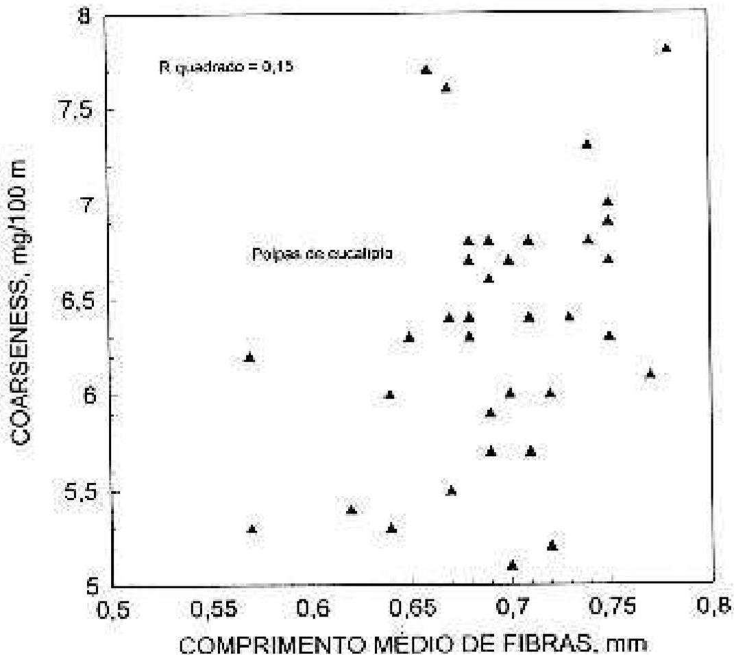
Da mesma forma como mostrado para as polpas de fibras longas de mercado, as fibras de eucalipto de modo geral não seguem uma correlação entre seu comprimento de fibra e seu "coarseness". Desta forma, a correlação só é válida para grupos muito diferentes de recursos fibrosos, ou em condições controladas dos recursos fibrosos e de processo industrial | por exemplo dentro de uma mesma fábrica.
