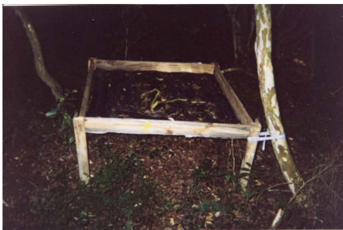
FIGURA 6 — Coletores utilizados no estudo de fluxo de sementes em Floresta Estacional Decidual Ripária, no Baixo Rio Jacuí, Cachoeira do Sul, RS, Brasil.
