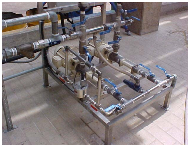
Figura 5. Sistema de dosagem desenvolvido para aplicação do aditivo de polpação.
