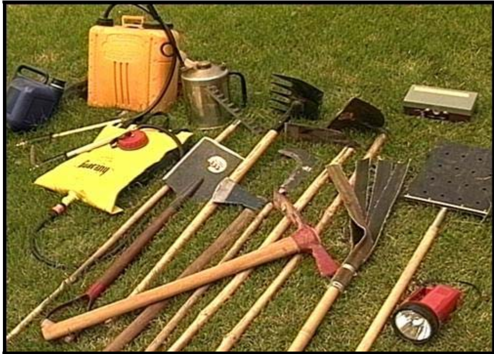
Figura 25: Algumas ferramentas equipamentos usados na extinção dos incêndios florestais (Fonte: UOV, 2004).
